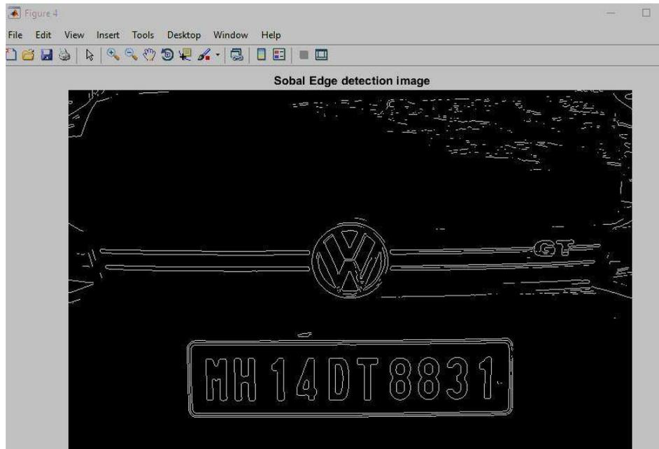
Figure 4: Vertical Edge detection.
