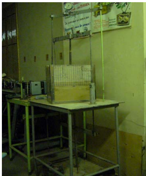
Рисунок 1: Вид установки и монолит лёссового грунта до нагружения и замачивания
