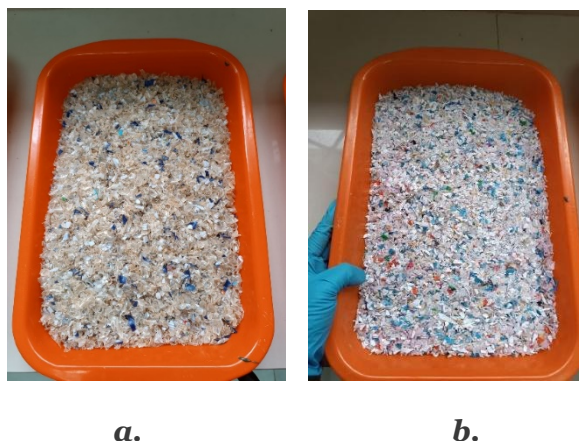
Figura 4: Residuos plásticos a. polietileno tereftalato (PET) y b. polipropileno (PP)
