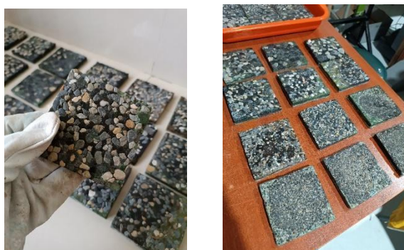
Figura 5: Eco-adoquines en sus diferentes proporciones plástico: árido
